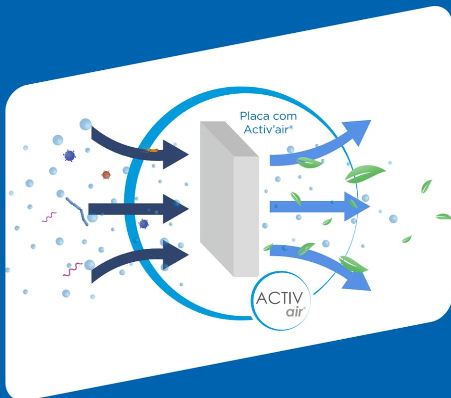
A tecnologia Activ'Air®, da marca Placo®, é uma solução inovadora que melhora a qualidade do ar, adequando-se a qualquer espaço e/ou ambiente interior. A tecnologia Activ'Air® purifica o ar, transformando os contaminantes da atmosfera interior (COV - compostos orgânicos voláteis) em compostos inertes e não prejudiciais.
