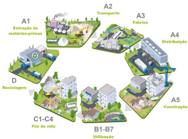
Figura 1: Ilustração do ciclo de vida de um produto de construção.
